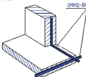
Пример устройства скважин от шпилек опалубки:
