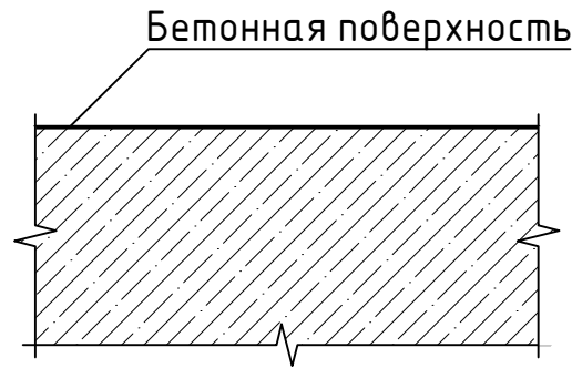
Поз. 3. Нанесение первого слоя ЦМИД-ФХ
