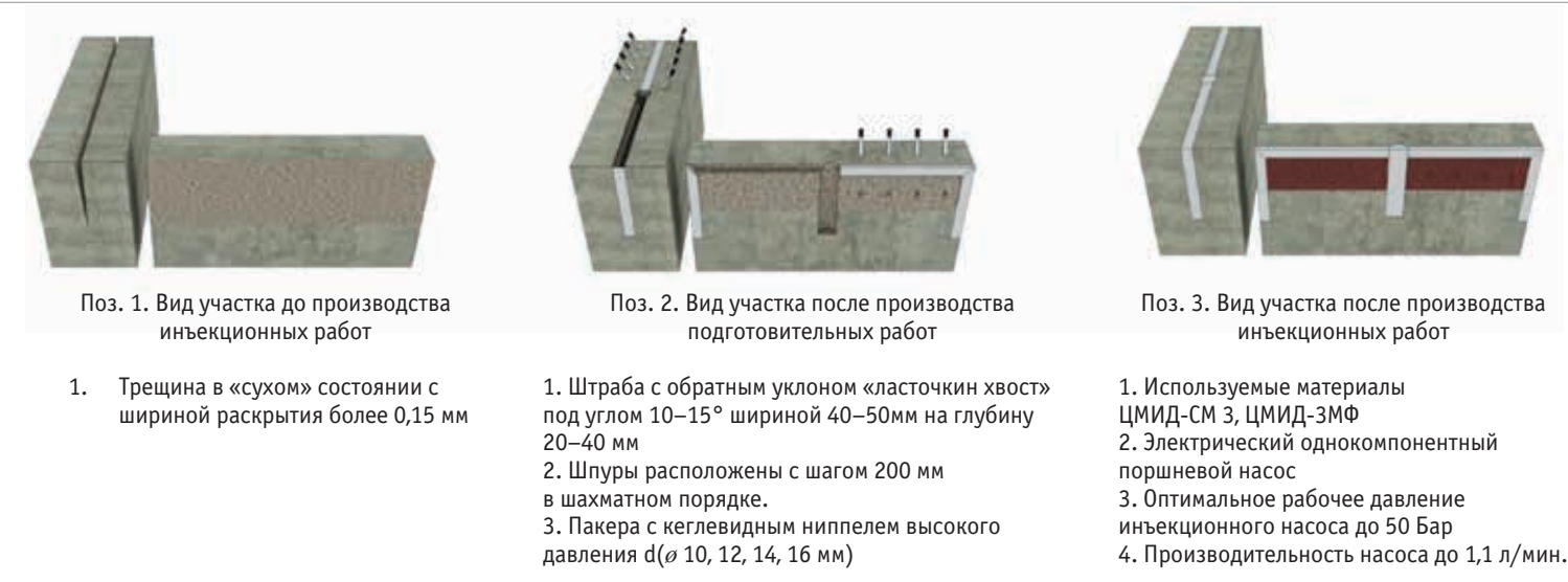
Рис. 3. Технология производства работ №4 по зачеканке трещин в сухом состоянии раскрытием более 0,15 мм (принцип 1, метод 1.5)
