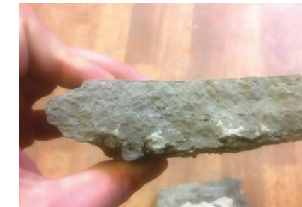
Рис. 2. Образец ремонтного материала класса R4 с бетонным основанием
