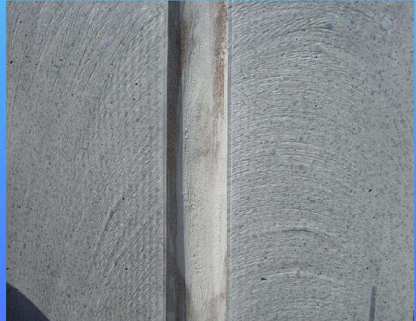
По результатам распиловки макетов подтверждена сплошность и монолитность конструкции.
