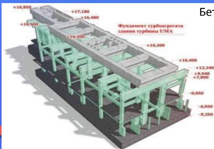
Бетонирование производилось одним блоком, с учетом повышенных требований по монолитности и трещиностойкости бетона.
