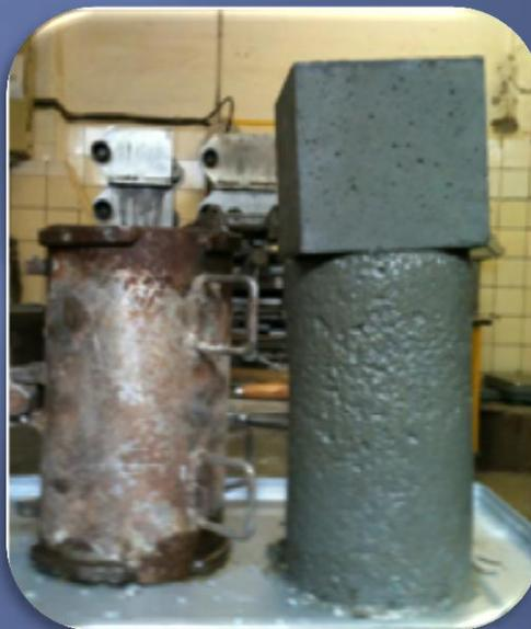
Цилиндрические образцы бетона через 8 часов после приготовления бетонной смеси. Минимальное давление на опалубку.
