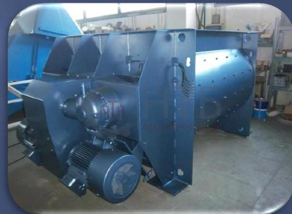
Высокопроизводительный двухвальный бетоносмеситель
